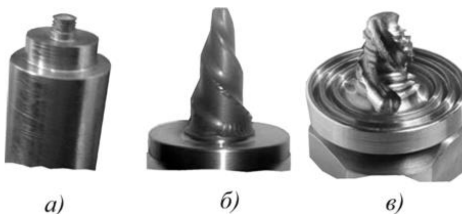
Рис. 4. Рабочие части инструментов используемых при ПСТ: а – традиционная конструкция инструмента; б – инструмент для получения глубоких швов; в – инструмент со специальной формой торца. Показан намазанный на выступ свариваемый металл.
