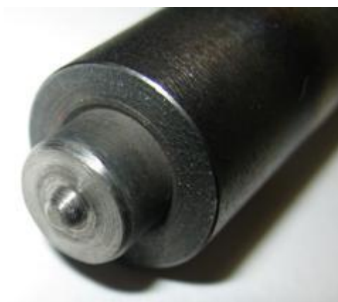
Рис. 17. Инструмент из твёрдого сплава WC6M для перемешивающей сварки трением алюминиевых сплавов толщиной 4 мм.
