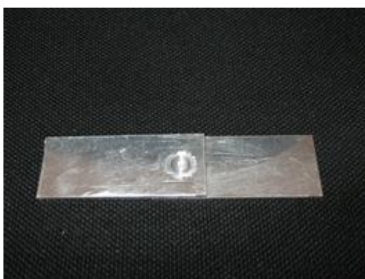
Рис. 12. Образец из алюминиевого сплава АМГ6 толщиной 1,2 мм, сваренный точечной сваркой трением.
