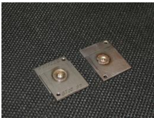
Рис. 11. Образцы из титанового сплава ВТ20 (слева) и никелевого сплава ХТ77ТЮР толщиной 1,5 мм, сваренные точечной сваркой трением.
