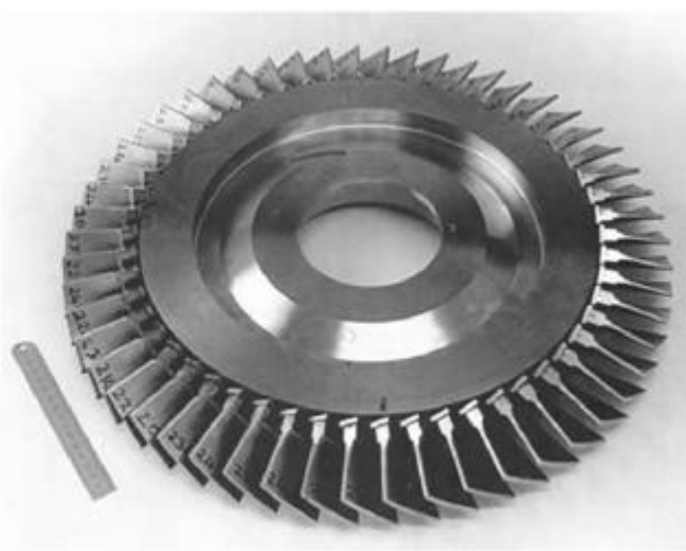
Рис.1. Линейная сварка трением и моноколесо с лопатками, приваренными линейной сваркой трением.
