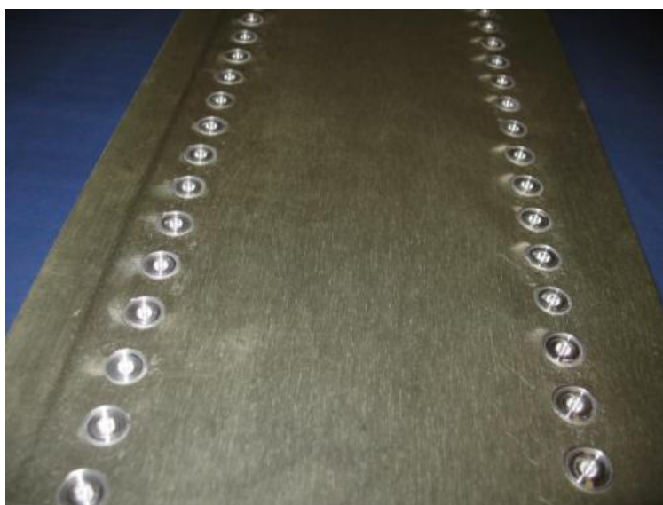
Рис. 3. Образец, полученный в ОАО «ВНИИАЛМАЗ» методом точечной сварки трением.
