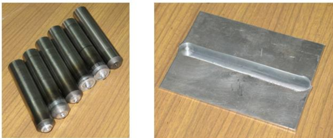
Рис. 6. Инструмент ПСТ и образец, полученный данным способом.
