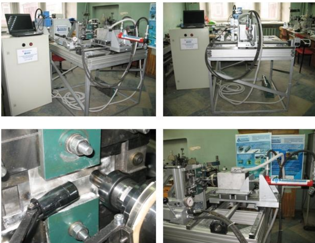
Рис. 5. Установка для перемешивающей сварки трением (ПСТ) алюминиевых сплавов толщиной до 4 мм.
