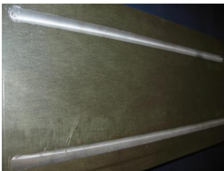
Рис. 4. Образец, полученный в ОАО «ВНИИАЛМАЗ» методом перемешивающей сварки трением.
