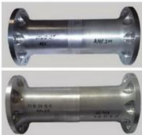
Рис. 13. Трубчатые детали из однородных и разнородных материалов, сваренные СТП.
