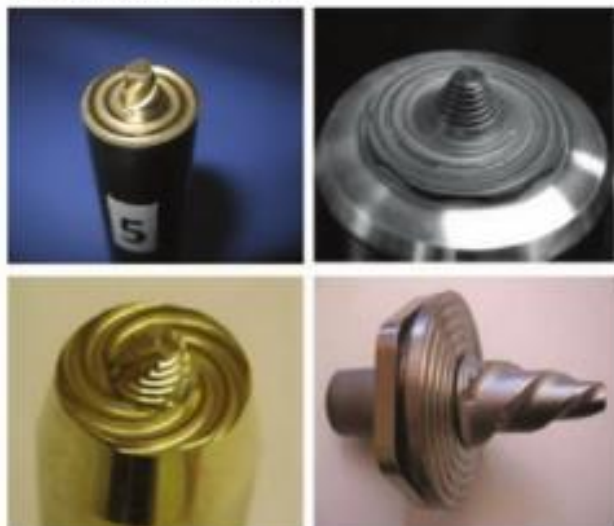
Рис. 4. Рабочие части инструментов для СТП.
