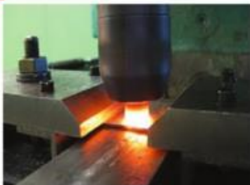
Рис. 10. Перемещающаяся сварка трением образцов из конструкционной стали инструментом из кубического нитрида бора.
