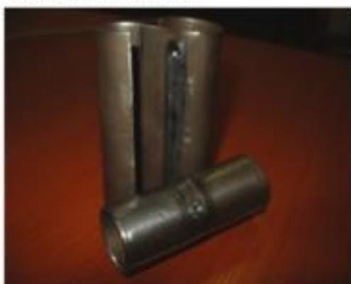
Рис. 11. Образец из конструкционной стали, изогнутый после сварки трением.
