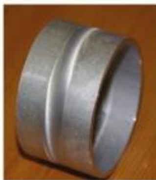
Рис. 15. Элемент трубы, сваренной СТП.
