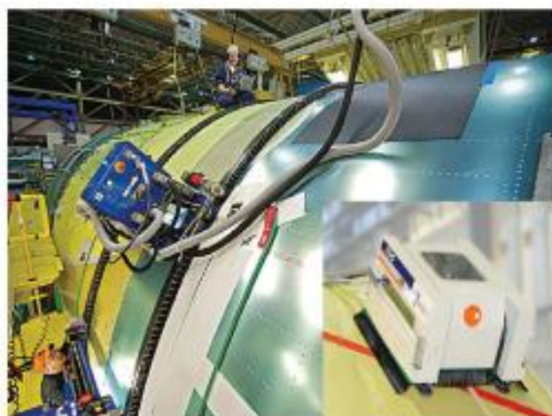
Рис. 7. Мобильные роботы для сверления отверстий и установки заклепок.
