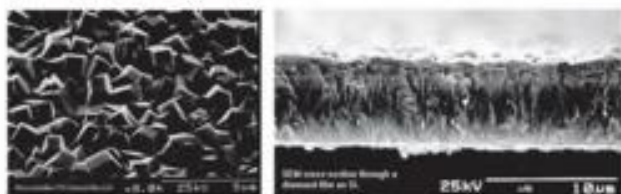
Рис. 3. Поверхность и структура алмазной пленки.
