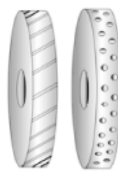
Рис. 5. Конструкции алмазных кругов: а — с прерывистым слоем; б — с перфорированными отверстиями
